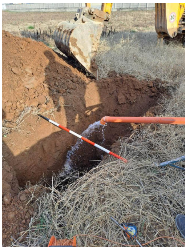
Figura 7 – Prova di permeabilità eseguita sull'area
